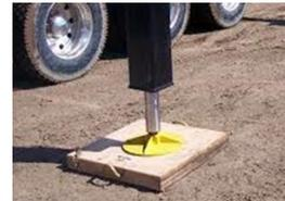
不同地面类型的地面承受能力不同。一般来说，岩石等较硬的地面可承受的地面压力高于干燥沙土等软质地面。如果地面由几种地面组合而成，应使用材质较差的地面来确定吊机安装在外伸支架上时地面可承受的最大地面压力。
